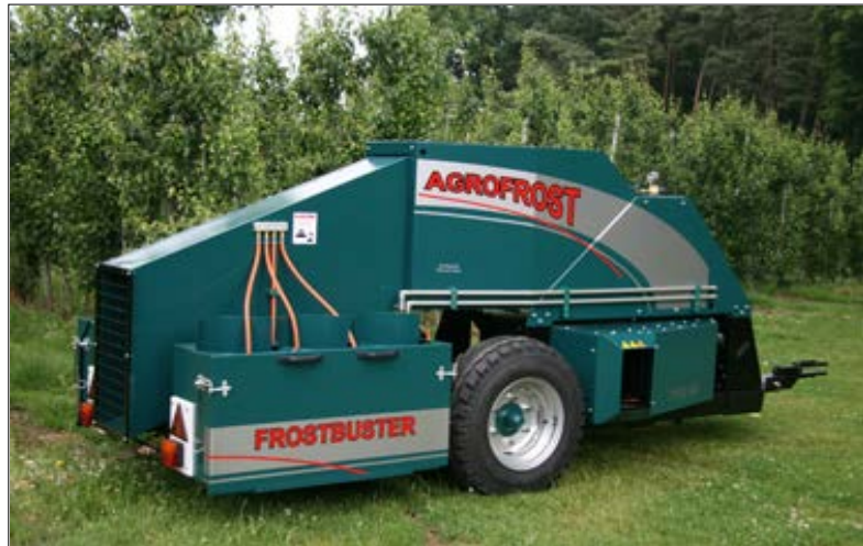
Frostbuster pokretni uređaj za zagrevanja voćnjaka i zaštitu od negativnog dejstva poznog prolećnog mraza (foto: http://www.agroffrost.eu/ ).
